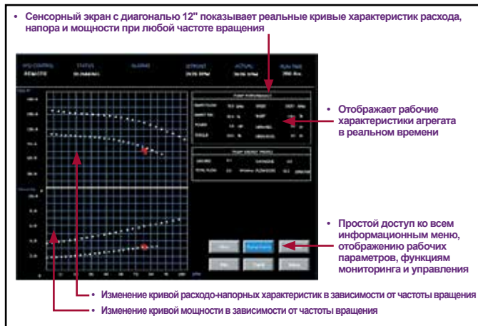
Рис. 2. Генератор динамической расходо-напорной характеристики насоса
